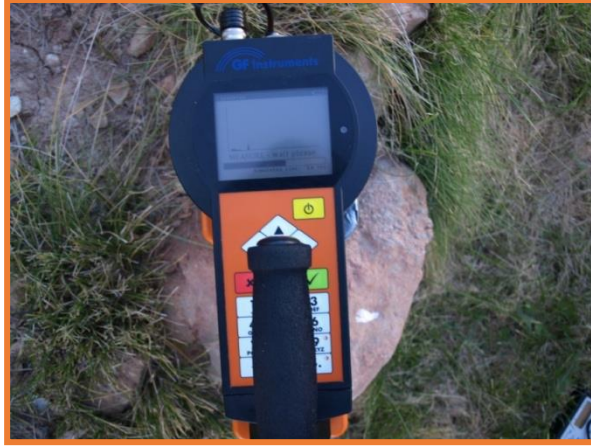
Şekil 3.4. Gama-ışın spektrometre cihazı
