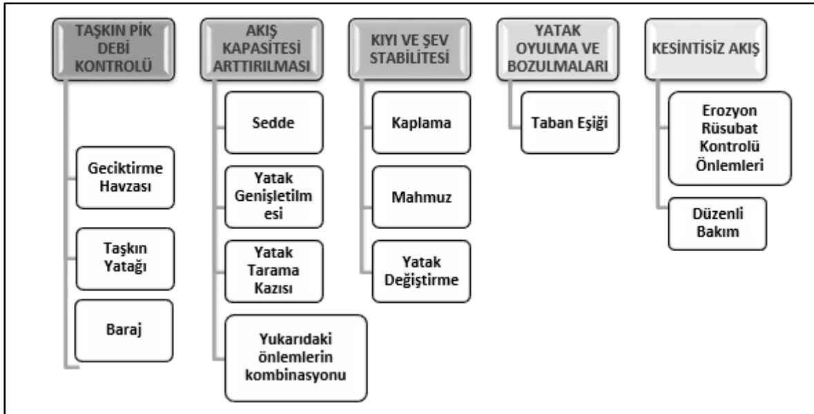
Şekil 20-1 Taşkın Azaltmada Uygulanan Yapısal Önlemler
