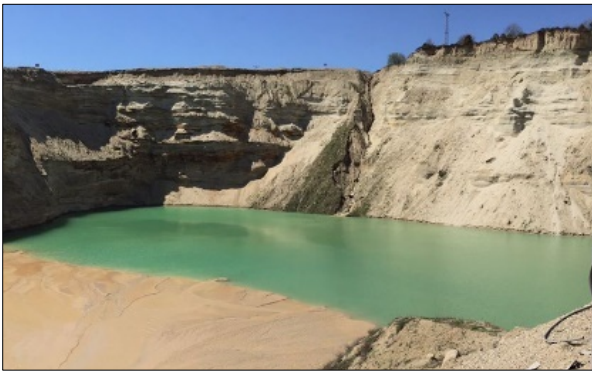
Şekil 6.3. İnşaat kumu üretim ocakları ve kum zenginleştirme ünitesi (Silivri, Beykum Madencilik; a, b, c, d). Kum üretim ocağı ve üretimden sonra ince malzemenin biriktirildiği mil havuzu (Silivri; Mertkum Madencilik; e, f). Kum üretim ocaklarının Google görüntüsünde ince malzemenin biriktirildiği mil havuzlarının alanları (Beykum Madencilik sahası; g).
