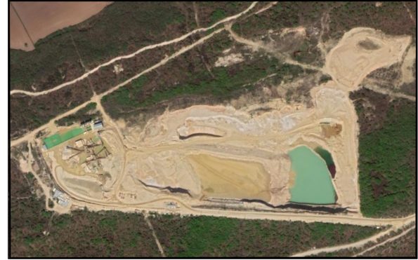
Şekil 6.3. İnşaat kumu üretim ocakları ve kum zenginleştirme ünitesi (Silivri, Beykum Madencilik; a, b, c, d). Kum üretim ocağı ve üretimden sonra ince malzemenin biriktirildiği mil havuzu (Silivri; Mertkum Madencilik; e, f). Kum üretim ocaklarının Google görüntüsünde ince malzemenin biriktirildiği mil havuzlarının alanları (Beykum Madencilik sahası; g).
