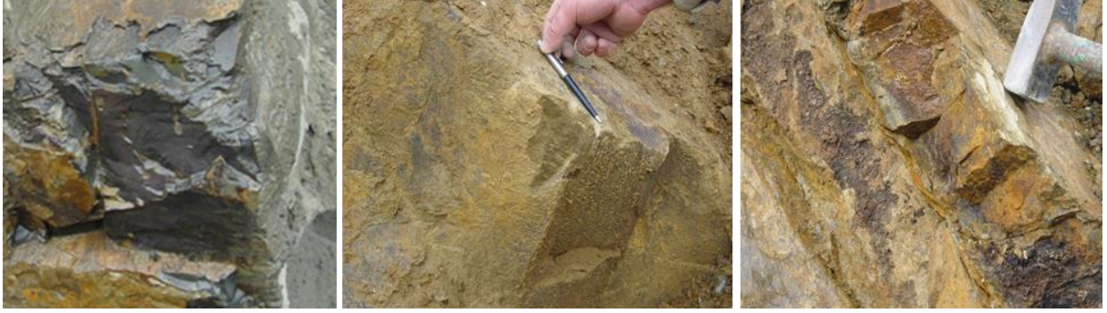
Şekil 4.19: Cendere Bölgesinde üretilen kumtaşlarının teze ve ayrıışmış kesimlerinin yakından görünümü. Ayrıışmış agregalar bölgede dolgu malzemesi olarak pazarlanmaktadır. Pazarlanamayanlar ise pasa olarak sahada bulunmaktadırlar.
